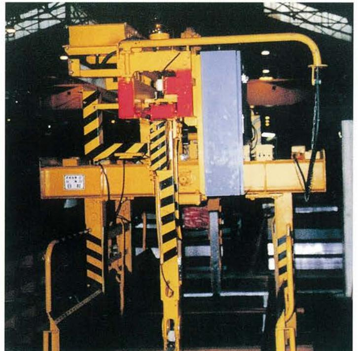
■ 7t 補爪付薄鋼板用シートリフタ
